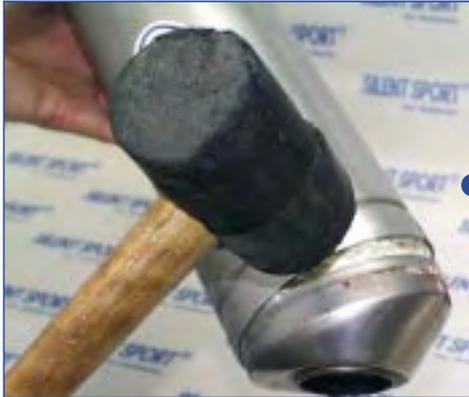
**Tipp!** Vor dem Ausbau der Eingangskappe etwas Kriechöl in den Spalt zwischen Gehäuse und Eingangskappe sprühen.
