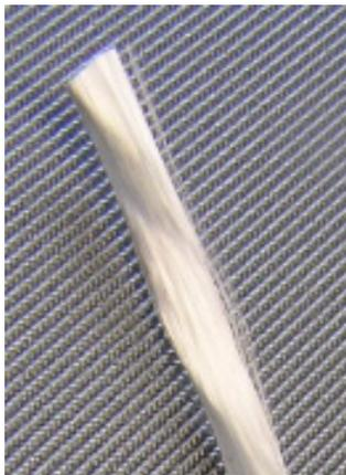
Filamente sind Faserbündel oder Faserstränge aus endlosen, unverdrehten, gestreckten Fasern.
